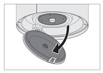
Führen Sie die Klappe mit der Unterschale langsam bis zum Anschlag nach unten.
