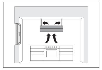
Das Gerät wird in der Betriebsart Umluftbetrieb verwendet:
